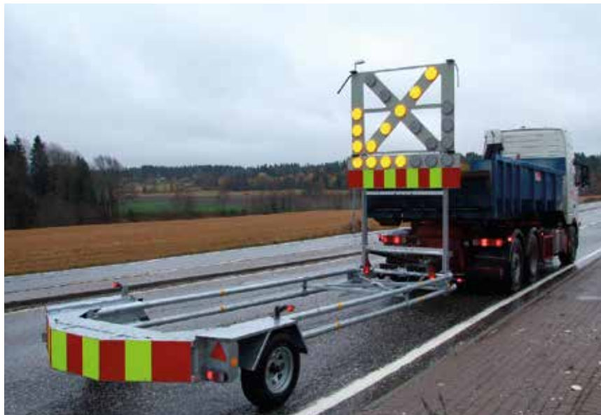
Vorteq TMA støtputehenger med varselpanel kobles til hengerfeste og omgjør lastebilen til en TMA støtputebil.
