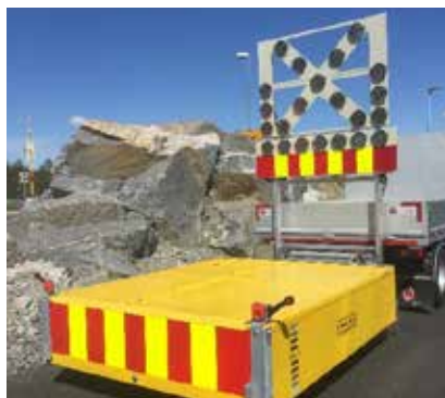
100K Julietta TMA bilmontert støtpute med varselpanel.
