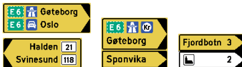
Figur 4-3.20 Eksempler på utforming av skilt 713 "Vanlig vegviser"
