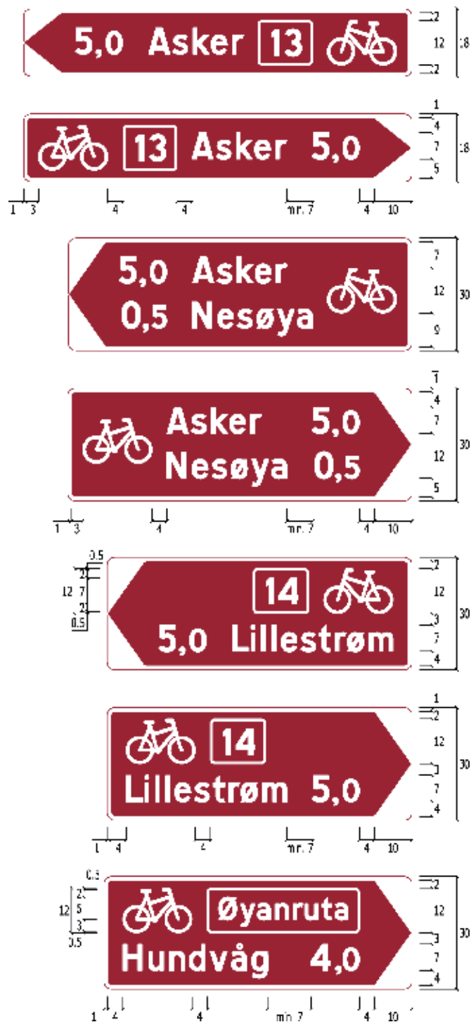
Figur 4-3.36 Utforming av skilt 751 "Vegviser for sykkelrute". Alle mål i 1/7 H.
