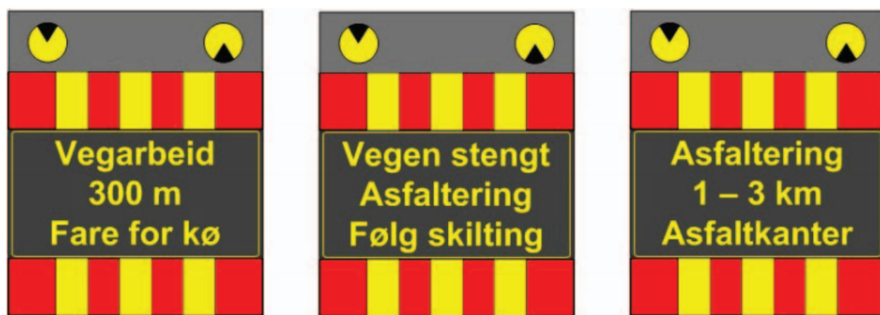
Figur 3.28 — Eksempler på skilt 560 på varselpanel
