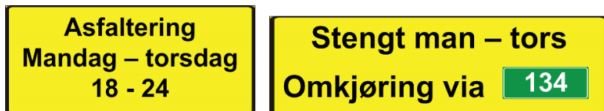
Figur 3.29 — Eksempler på skilt 560, arbeid på samme veglenke
